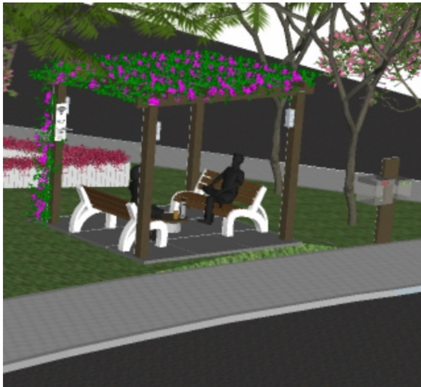
Modelo do Pergolado 3,30x3 m de concreto.
