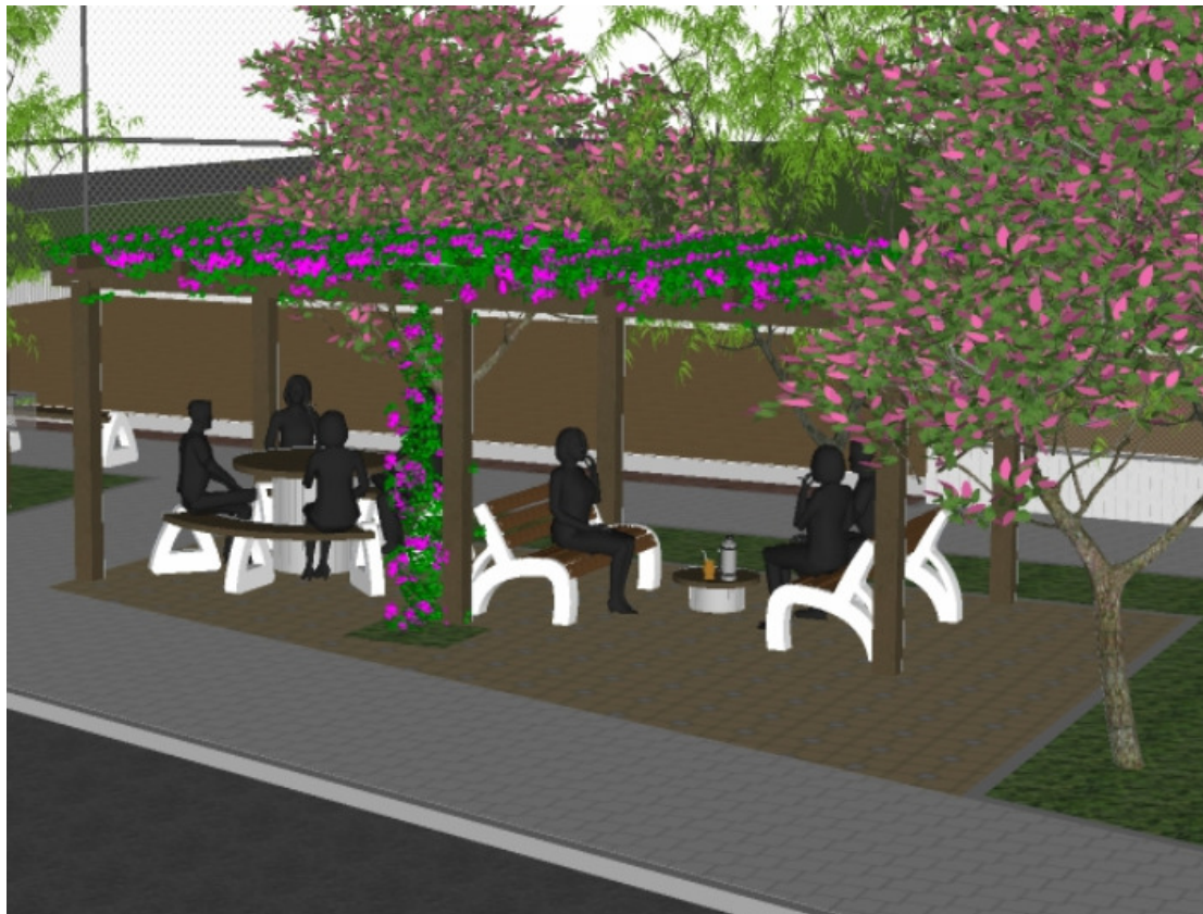
Modelo do Pergolado 6,60x3 m de concreto.
